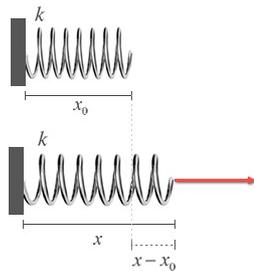
La ley de Hooke establece que el alargamiento de un resorte es directamente proporcional a la fuerza que se le aplique, siempre y cuando no se deforme permanentemente dicho resorte.
